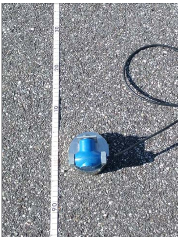
Dettaglio sensore trasversale con basetta
