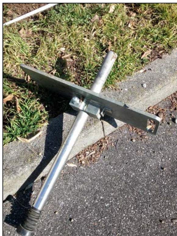
Dettaglio fucile sismico per energizzazione
