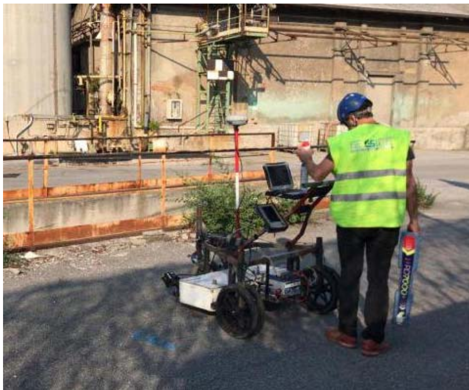
Foto - Rilievo Georadar con Georadar IDS Stream-X e rilievo con Radiolocalizzatore RD7000+
