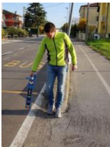
Immagine 12: Rilievo con RD7000 Plus della Radiodetection LTD e schema di funzionamento della strumentazione
